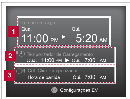
Temporizador de recarga ativado/Temporizador do Controle de Climatização ativado
