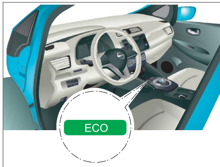
Interruptor do modo ECO (modelos sem o sistema ProPILOT Park) (se equipado)
