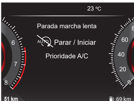
Orientação Start/Stop (ar-condicionado é prioridade)
