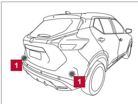
O sistema RCTA\* usa os sensores de radar **1** instalados em ambos os lados próximo ao para-choque traseiro para detectar a aproximação de veículos. Os sensores do radar **1** podem detectar a aproximação de um veículo até aproximadamente 20 m (66 pés) de distância.
