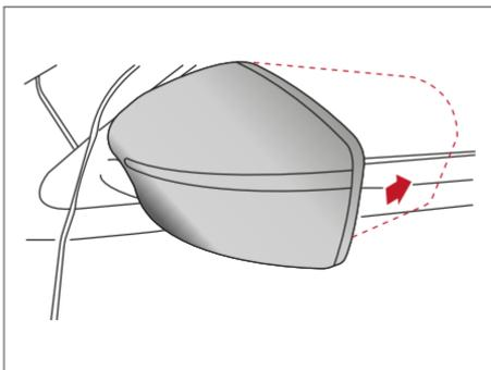
**Rebatimento elétrico dos espelhos retrovisores externos (se equipado)**
