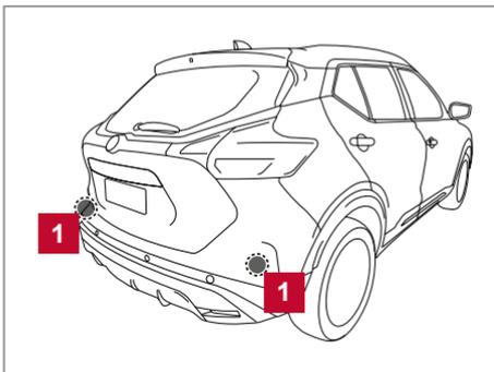
Os sensores de radar podem detectar veículos em ambos os lados do veículo dentro da área de detecção, conforme mostrado na ilustração. Essa área de detecção começa no espelho retrovisor externo do veículo e se estende aproximadamente 10 pés (3,0 m) atrás do para-choque traseiro e aproximadamente 10 pés (3,0 m) lateralmente.
