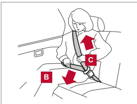
O modo de Travamento de Emergência do Retrator (ELR) pode travar e retraindo o cinto de segurança e possibilita que o motorista e os passageiros movimentem-se livremente sobre o banco. Este sistema foi projetado para travar o movimento do cinto de segurança se o cinto for puxado rapidamente do retrator, durante uma redução brusca de velocidade, para conter o movimento do corpo.
