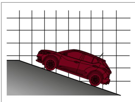
Quando a luz de advertência do controle de estabilidade
