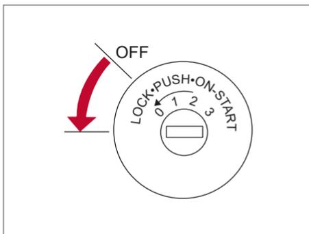
Para travar o volante de direção, gire o volante 1/8 de volta no sentido horário a partir da posição inicial.
