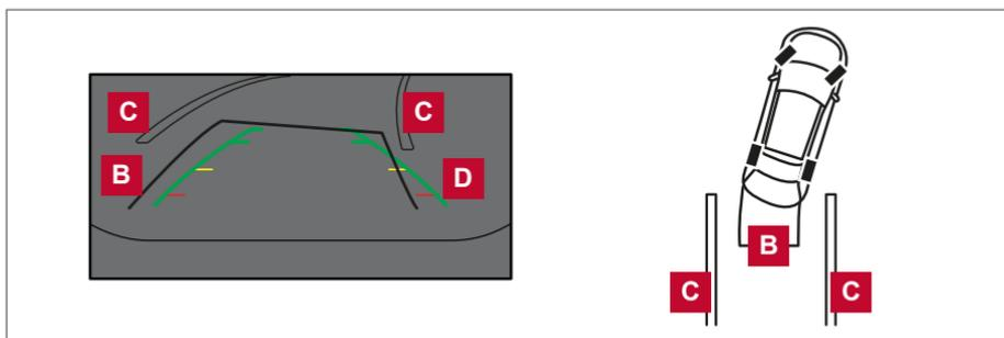
3. Manobre o veículo lentamente em marcha à ré fazendo com que as linhas de previsão de trajeto **B** se projetem para dentro da vaga de estacionamento **C**.
