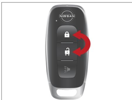
**NOTA:** Se você mudar as funções da buzina de resposta e lampejador do farol com a Chave Inteligente\*, o display de informações\* mostrará o modo atual após o botão de partida\* ser colocado da posição OFF para ON. O display de informações\* também pode ser usado para alterar o modo de buzina de resposta.
