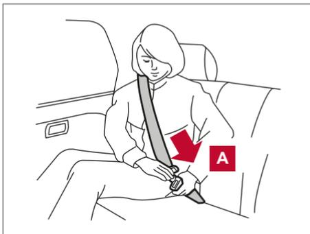
3. Posicione o cinto de segurança na parte abdominal **B** de forma que fique encostado na altura dos quadris (conforme ilustrado).
