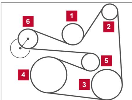
1. Inspeção visualmente a correia quanto a sinais de desgaste incomum, cortes ou rachaduras. Caso a correia esteja em condições insatisfatórias, providencie para que seja substituída ou ajustada em uma concessionária Nissan.
