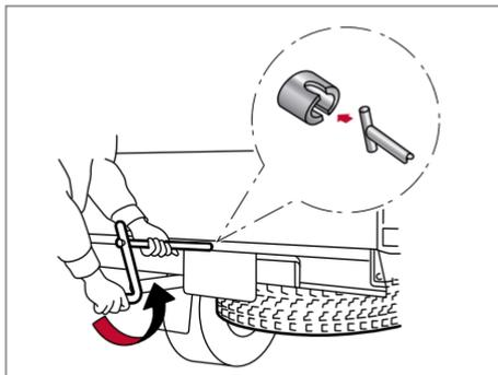
6. Quando o pneu reserva estiver completamente abaixado, retire a haste da abertura oval e remova a corrente de retenção do pneu, conforme mostrado.
