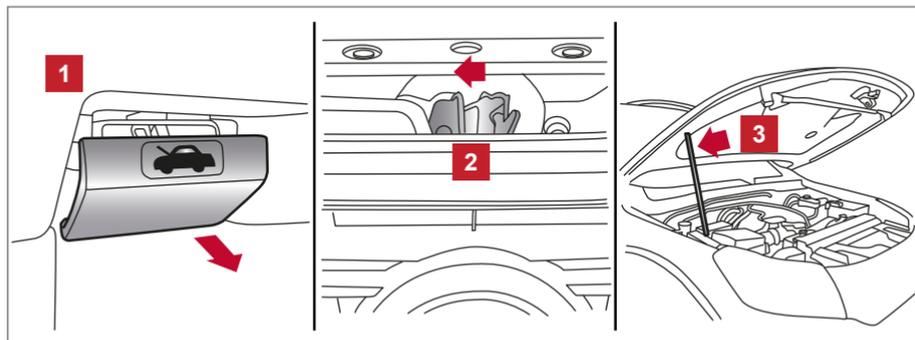
1. Puxe a alavanca de liberação da tampa do capô do motor **1**, localizada abaixo do painel de instrumentos, lado do motorista; o capô irá saltar levemente.
