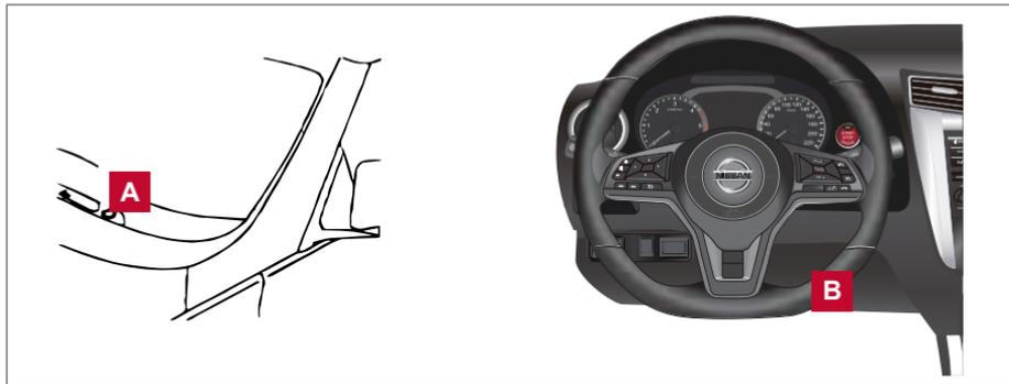
Os sensores **A** e **B** (se equipado) de carga solar, localizado no painel de instrumentos, auxilia o sistema a manter uma temperatura constante. Não coloque nada sobre ou ao redor do sensor.
