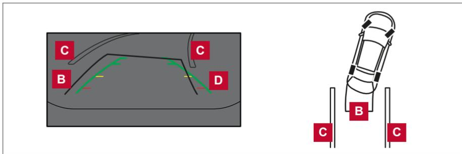
3. Manobre o veículo lentamente em marcha a ré fazendo com que as linhas de previsão de trajeto **B** se projetem para dentro da vaga de estacionamento **C**.
