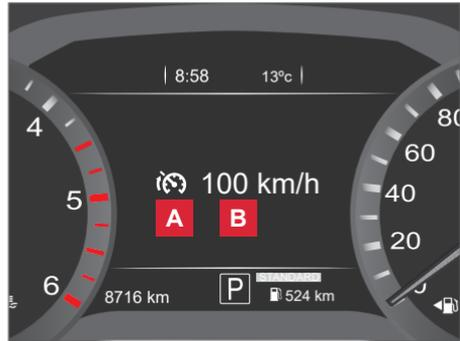
**O limitador de velocidade não irá reduzir a velocidade do veículo de forma automática até a velocidade definida.**
