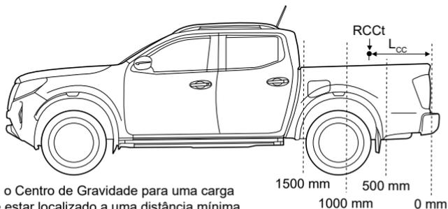
Neste exemplo, o Centro de Gravidade para uma carga de 866 Kg deve estar localizado a uma distância mínima de 755 mm a partir da parte interna da tampa traseira.
