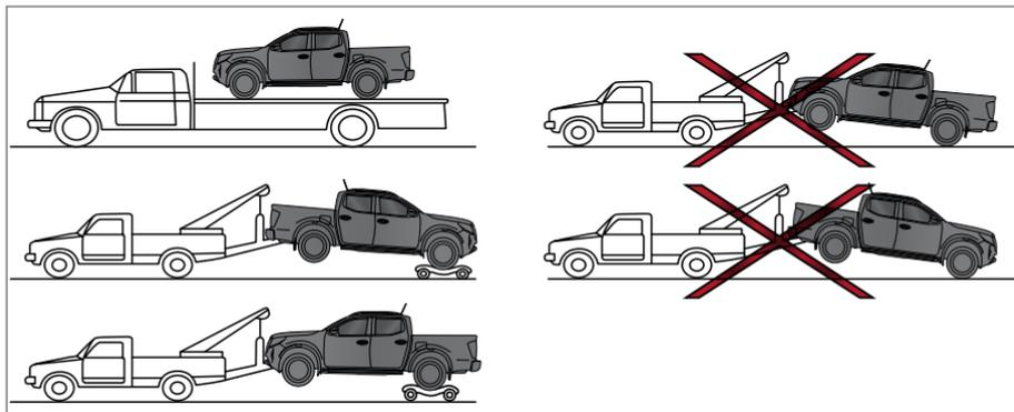
A Nissan recomenda que carrinhos de reboque sejam utilizados ao rebocar o seu veículo ou colocar o veículo em um caminhão com plataforma, como ilustrado.
