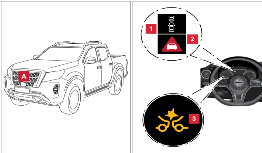
O sistema FEB\* utiliza um sensor de radar **A** localizado na frente do veículo para medir a distância do veículo à frente e na mesma faixa.
