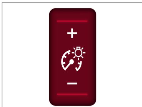
Pressione o lado + do interruptor para iluminar as luzes do painel do medidor. A barra **1** move-se para o lado +.
