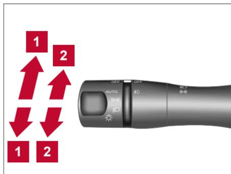
As luzes indicadoras de direção irão piscar por três ciclos automaticamente.
