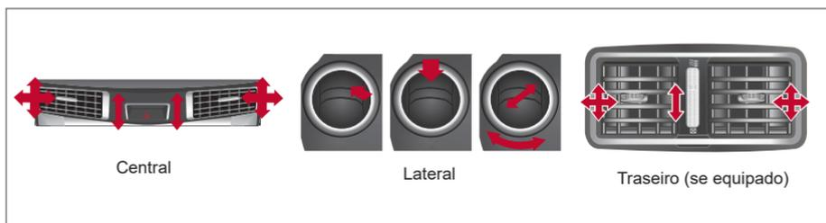
Ajuste a direção do fluxo de ar dos difusores centrais, laterais e traseiros\* movendo as aletas e/ou os conjuntos dos difusores. Abra ou feche os difusores usando o seletor. Mova o seletor na direção para abrir os difusores ou para fechá-los.
