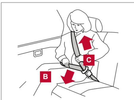
O modo de Travamento de Emergência do Retrator (ELR) permite que o cinto de segurança se estenda e retraia para permitir que o motorista e os passageiros movimentem-se livremente no banco. Durante uma desaceleração rápida do veículo ou durante uma colisão, o ELR trava o cinto de segurança para conter o movimento do corpo.
