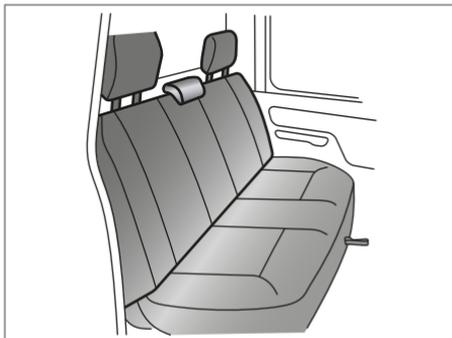
Ao viajar no banco central traseiro, o apoio para cabeça central (não ajustável) do banco traseiro deve ser puxado para cima até a posição mais elevada. Certifique-se de que o apoio para cabeça esteja posicionado com o botão de travamento encaixado na cavidade da haste antes de conduzir o veículo.
