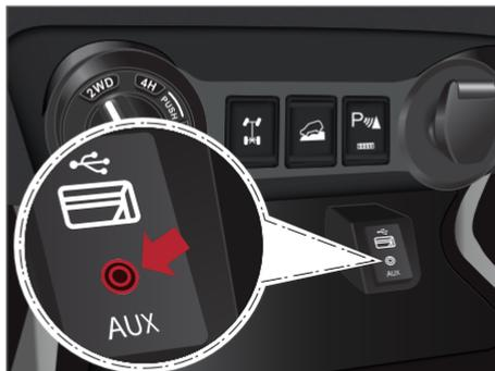
A NISSAN recomenda a utilização de um cabo estéreo para a conexão do seu dispositivo de música ao sistema de áudio. Caso seja utilizado um cabo mono, o arquivo de música poderá não ser reproduzido adequadamente.
