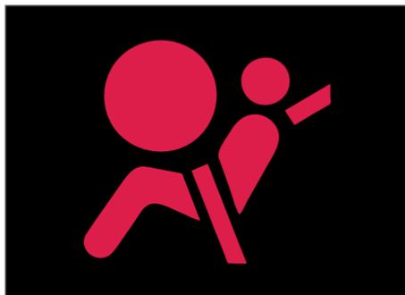
A luz de advertência do air bag se apagará após 7 segundos, se os sistemas dos air bags estiverem funcionando adequadamente.
