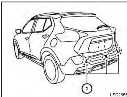
Não cole adesivos (incluindo os materiais transparentes), instale acessórios ou aplique pintura adicional próximo aos sensores.
