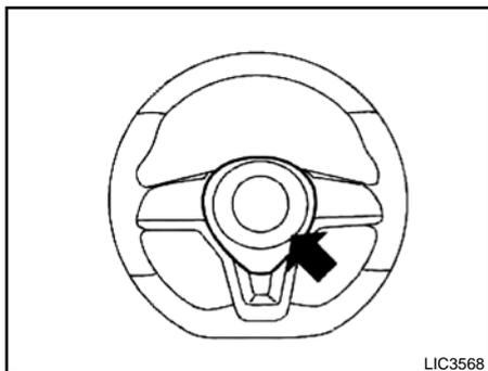
Para acionar a buzina, pressione o volante da direção próximo ao símbolo.
