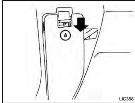
O interruptor de armazenamento estendido é usado quando o veículo está sendo transportado da fábrica. Ele está localizado na caixa de fusíveis (A), atrás da parte inferior esquerda do painel de instrumentos, próximo ao assoalho. Se algum equipamento elétrico não funcionar, certifique-se de que o interruptor de armazenamento estendido esteja devidamente encaixado, como mostrado.
