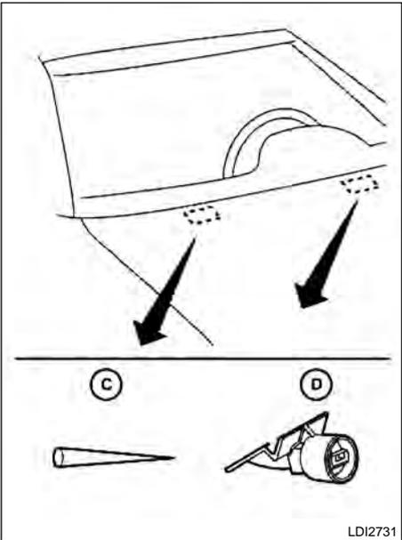
Cuidado para não deixar que nada penetre no bocal do lavador. Isto pode causar entupimento ou funcionamento incorreto do lavador de para-brisa ④. Caso alguma coisa penetre no ejetor, remova-a com uma agulha ou um pino pequeno ③.
