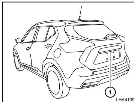
Se a câmera ① estiver com sujeira, respingos de chuva ou flocos de neve poderá não exibir os objetos. Limpe a câmera utilizando um pano com detergente neutro, em seguida utilize um pano seco.
