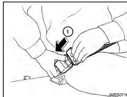
③ Posicione o cinto de segurança **de forma que fique encostado no corpo na altura dos quadris** (conforme a ilustração).
