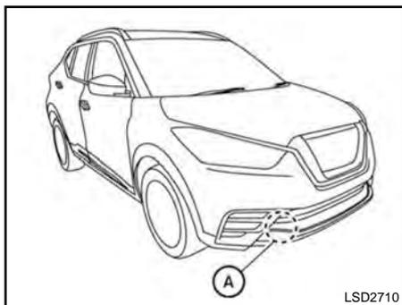
O sistema FEB\* utiliza um sensor de radar **A** localizado na frente do veículo para medir a distância do veículo à frente e na mesma faixa.
