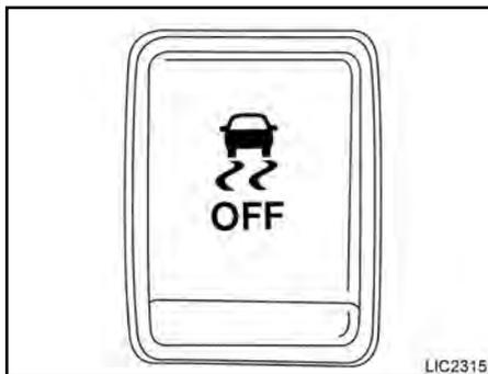
Pressione novamente o interruptor (VDC) OFF\* ou dê partida no motor novamente para ligar o sistema. Para mais informações, consulte “Sistema do controle de estabilidade (VDC) (se equipado)” na seção “Funcionamento e operação” deste manual.
