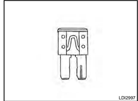
Se qualquer equipamento elétrico não funcionar, verifique se algum fusível está queimado.
