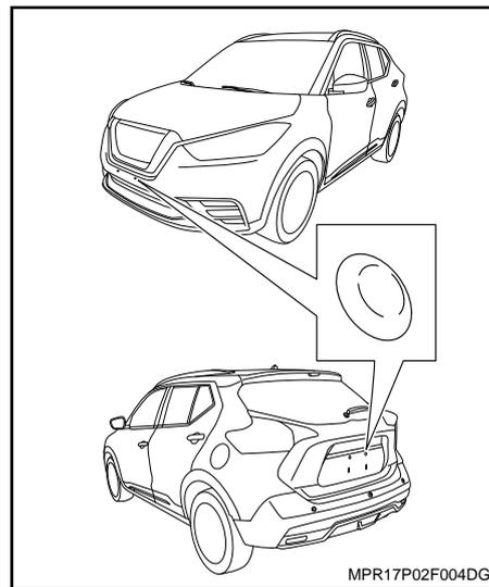
Para alinhar a placa de licença, existem duas marcações na cobertura do para-choque dianteiro e na porta traseira que indicam a posição correta de cada parafuso.
