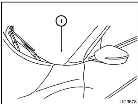
Certifique-se de não colocar nada em cima do sensor do acendimento inteligente dos faróis\* localizado na parte superior ① do painel de instrumentos. Se o mesmo for coberto, o sistema conclui que está escuro e acende os faróis. Se isto ocorrer quando deixar o veículo com o motor desligado e o interruptor de ignição\* na posição ON, a bateria do veículo será descarregada.
