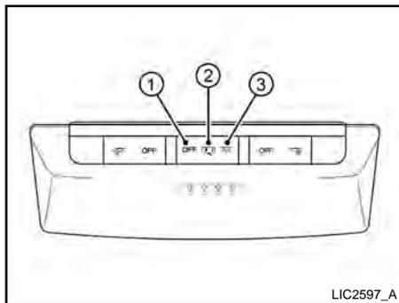
A luz interna possui um interruptor de três posições e funciona independentemente da posição do interruptor de ignição\*.
