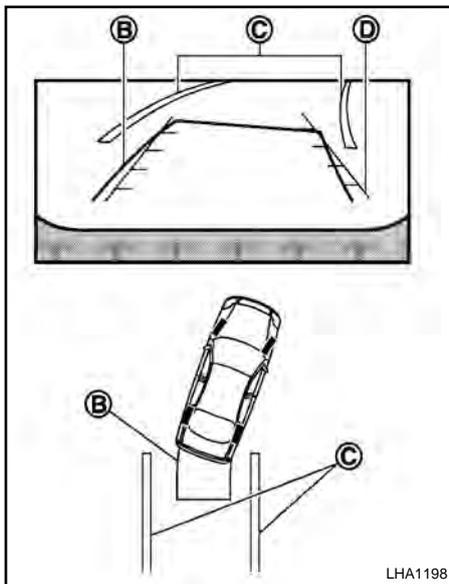
3. Manobre o veículo lentamente em marcha a ré fazendo com que as linhas de previsão de trajeto **B** se projetem para dentro da vaga de estacionamento **C**.
