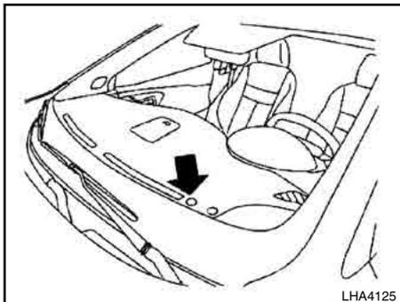
O sensor de carga solar, localizado na parte superior (lado do motorista) do painel de instrumentos, auxilia o sistema a manter uma temperatura constante. Não coloque nada sobre ou ao redor do sensor.
