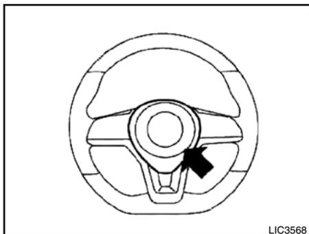
Para acionar a buzina, pressione o volante da direção próximo ao símbolo.
