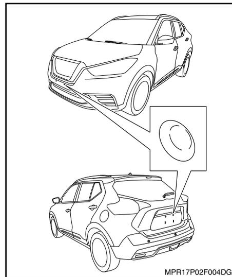
Para alinhar a placa de licença, existem duas marcações na cobertura do para-choque dianteiro e na porta traseira que indicam a posição correta de cada parafuso.
