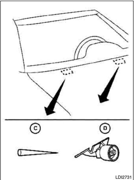
Cuidado para não deixar que nada penetre no bocal do lavador. Isto pode causar entupimento ou funcionamento incorreto do lavador de para-brisa (D). Caso alguma coisa penetre no ejetor, remova-a com uma agulha ou um pino pequeno (C).
