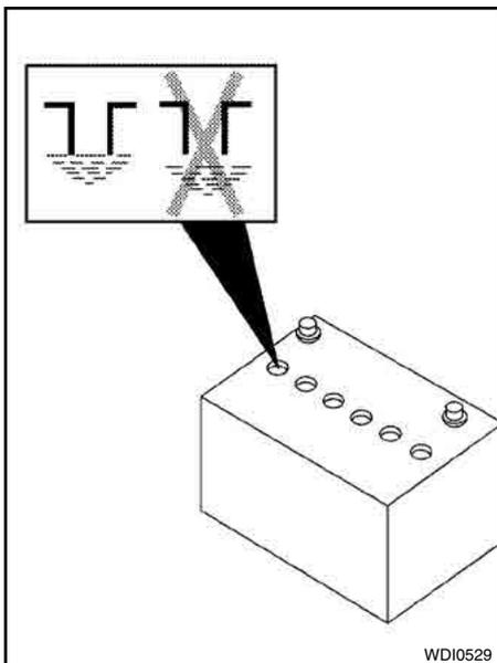
2. Verifique o nível de fluido em cada célula. Caso seja necessário adicionar fluido, adicione somente água destilada para completar o nível até a abertura de abastecimento. **Não coloque o fluido em quantidade excessiva.** Reinstale as tampas de respiro.
