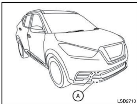
O sistema FEB\* utiliza um sensor de radar **A** localizado na frente do veículo para medir a distância do veículo à frente e na mesma faixa.
