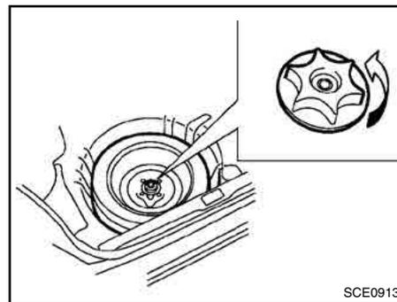
2. Para remover o macaco, solte-o de sua fixação, girando o engate da haste na extremidade do macaco manualmente e no sentido anti-horário. Se necessário, remova o pneu reserva primeiramente para facilitar o acesso.
