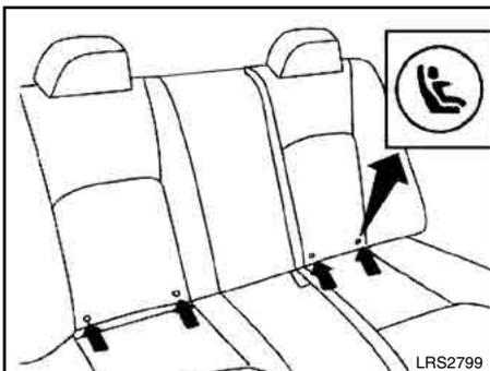
Localizações dos pontos de ancoragem inferiores do sistema ISOFIX/LATCH (se equipado)
