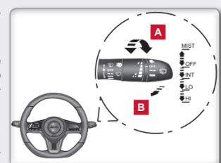
A função intermitente dependente da velocidade do veículo pode ser habilitada/deshabilitada acessando "Definições" no menu do display, "Definições do veículo", "Limpador de para-brisa".
