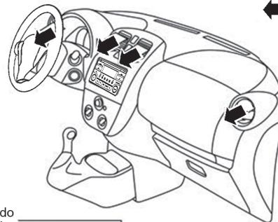
Fluxo de ar não passa pelo núcleo do aquecedor
