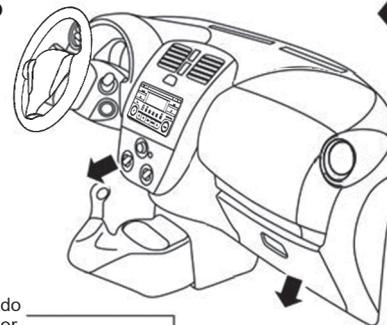
← : Fluxo de ar passa pelo núcleo do aquecedor
