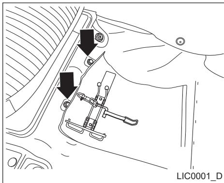
O seu veículo está pré-disposto para instalação de extintor de incêndio, bem como do seu suporte. O local para fixação encontra-se abaixo do assento frontal do passageiro.
