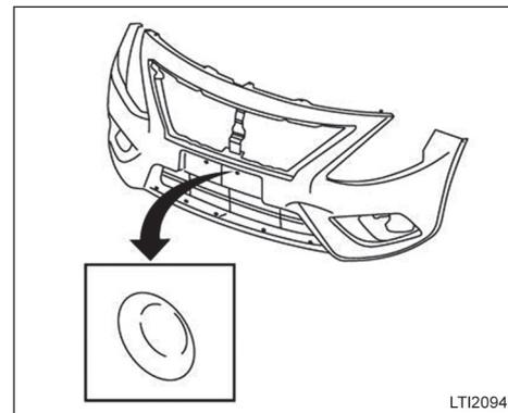
Para alinhar a placa de licença, existem duas marcações na cobertura do para-choque indicando a correta posição de cada parafuso.
