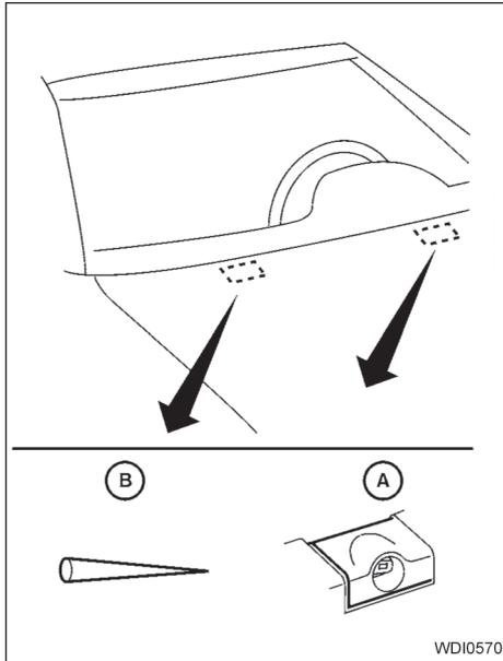
Cuidado para não deixar que nada penetre no bocal do lavador. Isto pode causar entupimento ou funcionamento incorreto do lavador de para-brisa (A). Caso alguma coisa penetre no ejetor, remova-a com uma agulha ou um pino pequeno (B).
