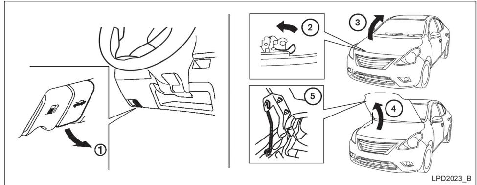
1. Puxe a alavanca de liberação da trava do capô do motor ① localizada abaixo do painel de instrumentos até a liberação suave das molas do capô.
