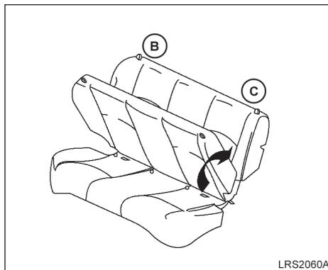
2. Para retornar o encosto traseiro para a posição vertical, levante o encosto e empurre-o para a posição. Pressione firmemente as zonas **B** e **C** para travar o encosto no lugar.
