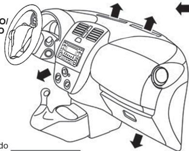
Fluxo de ar passa pelo núcleo do aquecedor
