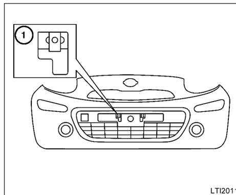
Instale a placa de licença no suporte da placa de licença ① usando dois parafusos M6-14 mm (não fornecidos) para rosquear nas porcas. Centralize a placa de licença no suporte e aperte firmemente.
