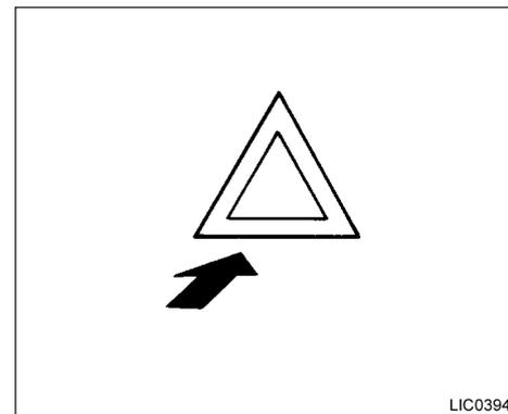
Pressione o interruptor para alertar outros motoristas quando você precisar parar ou estacionar em virtude de alguma situação de emergência. Todas as luzes indicadoras de direção piscam.
