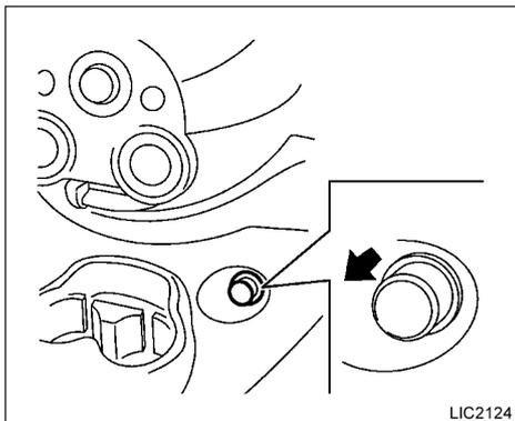
A tomada de força é destinada a fornecer energia para acessórios, tais como telefones celulares. A alimentação de saída é de 12 volts, máximo 240 W (20A).
