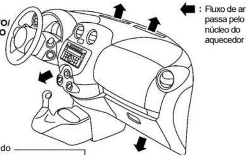
← : Fluxo de ar passa pelo núcleo do aquecedor
