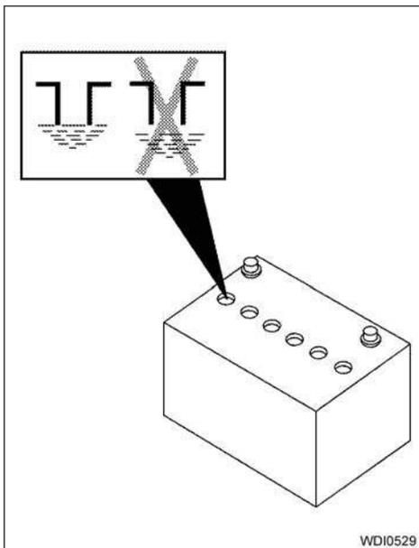
2. Verifique o nível de fluido em cada célula. Caso seja necessário adicionar fluido, adicione somente água destilada para completar o nível até a abertura de abastecimento. **Não coloque o fluido em quantidade excessiva.** Reinstale as tampas de respiro.
