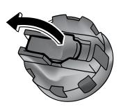
Levante a cobertura do cilindro da chave na tampa do reservatório.
