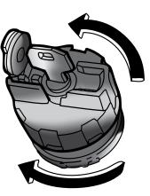
Para travar, remova a chave, feche a cobertura do cilindro e gire no sentido horário até ouvir os cliques da catraca. Automaticamente a tampa será travada guando rosqueada.
