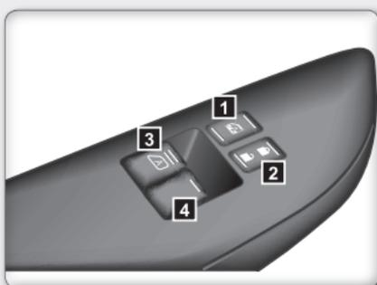
**NOTA:** Para acionar os interruptores dos vidros elétricos, pressione para abrir e puxe para fechar.
