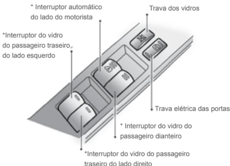
\*Para acionar os interruptores dos vidros elétricos, pressione para abrir e puxe para fechar.
