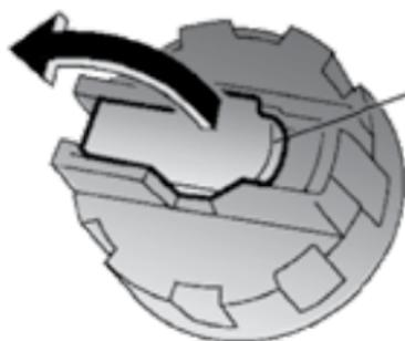
Levante a cobertura do cilindro da chave na tampa do reservatório
