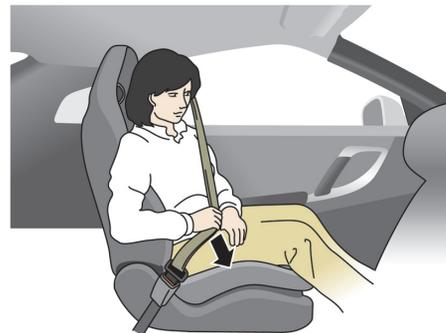
3. Coloque a secção inferior do cinto em **posição baixa sobre a anca**, de acordo com a figura.
