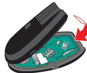
3. Remova a pilha antiga e insira uma nova pilha com o lado + virado para baixo.
