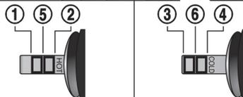
Verifique o nível do fluido no depósito. Retire a tampa que está fixa com um manómetro incorporado.
