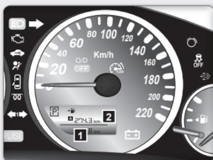
O hodômetro / hodômetro parcial duplo será exibido quando o interruptor de ignição estiver na posição “ON”.
