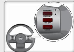
O controle de velocidade permite dirigir nas velocidades entre 40 a 160 km/h, sem a necessidade de manter o pé no pedal do acelerador.
