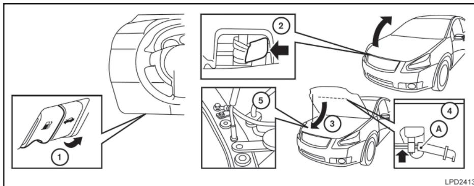
1. Puxe a alavanca de liberação do capô ① localizada abaixo do painel de instrumentos do lado do motorista; o capô irá abrir levemente.
