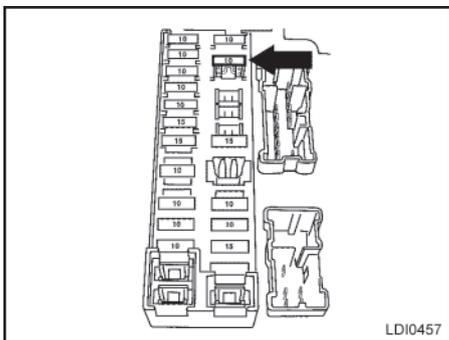
Se um fusível tipo **A** for usado para substituir um fusível tipo **B**, o fusível tipo **A** não ficará nivelado com o alojamento de fusíveis (conforme mostrado na ilustração). Isso não afetará o desempenho do fusível. Certifique-se de que o fusível esteja instalado na caixa de fusíveis com segurança.
