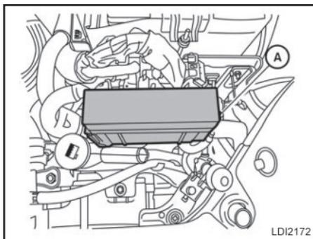
3. Remova a tampa da caixa de fusíveis empurrando a aba **A** e levantando a tampa para cima.
