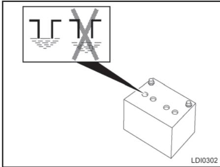
2. Verifique o nível de fluido em cada célula. Caso seja necessário adicionar fluido, adicione somente água destilada para completar o nível até a abertura de abastecimento. Não coloque o fluido em quantidade excessiva.
