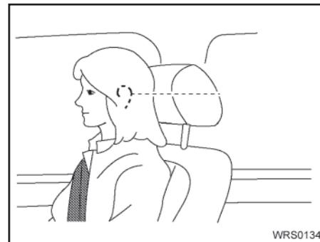
A figura mostra as posições dos bancos equipados com apoio para cabeça. Os apoios para cabeça da segunda fileira de bancos podem ser removidos, mas não ajustados.
