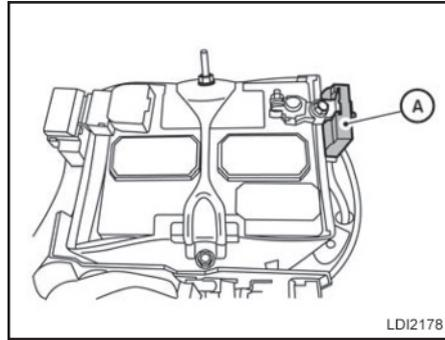
O sensor de corrente **A** está localizado próximo à bateria em frente ao cabo negativo da bateria. Se você adicionar acessórios elétricos no seu veículo, certifique-se de aterrá-los no massa da carroceria adequado como chassi ou área do bloco do motor.
