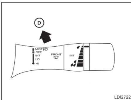
7. Por último, empurre a alavanca do limpador do para-brisa e lavador para a posição MIST ④ uma vez e libere-a. Isto resultará na retomada dos limpadores para a posição ajustada.
