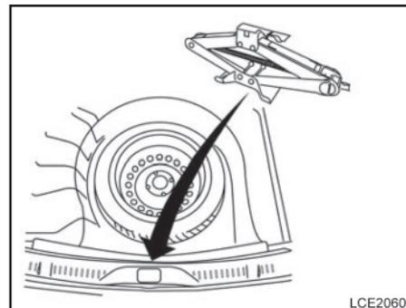
9. Instale o macaco em seu compartimento de armazenagem e aperte a cinta do macaco.
