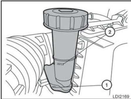
Verifique o nível de fluido no reservatório. Se o fluido de freio estiver abaixo da marca MIN ①, ou se a luz de advertência do freio se acender, adicione Fluido de Freio Genuíno Nissan ou equivalente **DOT 3** até a linha MAX ②. Caso o fluido necessite ser adicionado frequentemente, o sistema deverá ser inspecionado em uma concessionária Nissan.
