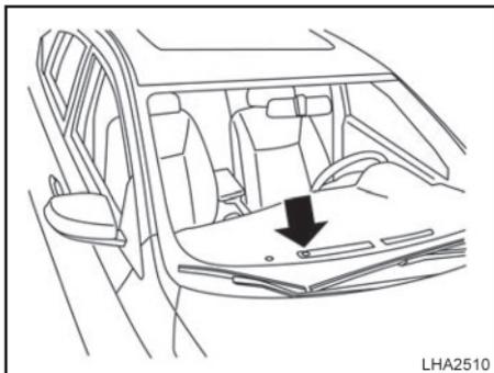
O sensor de carga solar, localizado na parte superior do painel de instrumentos, auxilia o sistema a manter uma temperatura constante. Não coloque nada sobre ou ao redor do sensor.
