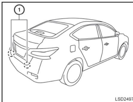
O sistema RCTA utiliza sensores de radar ① instalados próximos ao para-choque traseiro, em ambos os lados, para detectar a aproximação de um veículo.
