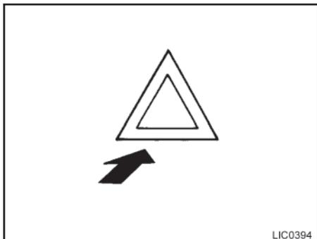
Pressione o interruptor para alertar outros motoristas quando você precisar parar ou estacionar, em virtude de alguma situação de emergência. Todas as luzes indicadoras de direção irão piscar com o botão de partida em qualquer posição.
