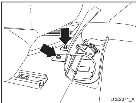
O seu veículo está pré-disposto para instalação de extintor de incêndio, bem como do seu suporte. O local para fixação encontra-se abaixo do assento frontal do passageiro.
