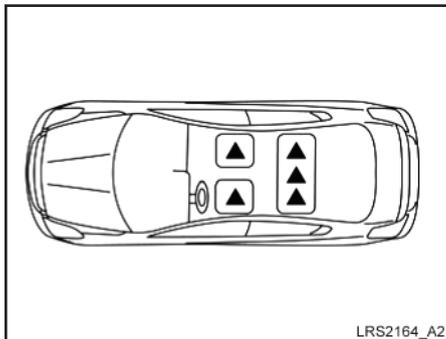
A figura mostra as posições dos bancos equipados com apoio para cabeça. Os apoios para cabeça da 1ª fileira de bancos são ajustáveis.
