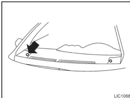
Certifique-se de não colocar nada em cima do sensor do sistema de iluminação automática localizado na parte superior do painel de instrumentos. Se o mesmo for coberto, o sistema conclui que está escuro e acende os faróis. Se isto ocorrer quando deixar o veículo com o motor desligado e o botão de partida na posição ON, a bateria do veículo será descarregada.
