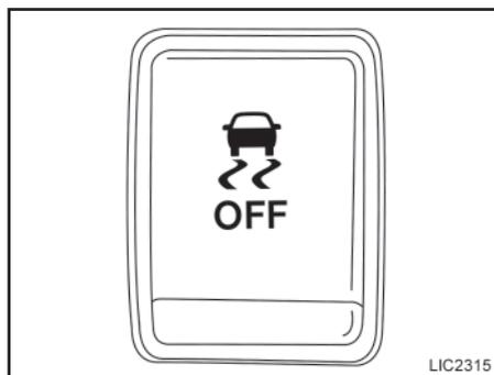
Pressione novamente o botão VDC OFF ou dê partida no motor novamente para ligar o sistema. Para mais informações, consulte “Sistema do controle de estabilidade (VDC)” na seção “Funcionamento e operação” deste manual.
