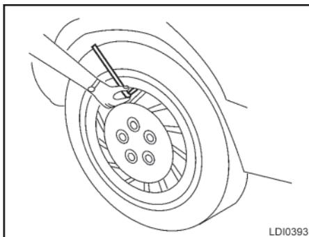
5. Adicione ar ao pneu, se for necessário. Caso seja adicionado ar em demasia, pressione o núcleo da haste da válvula para liberar a pressão. Verifique a pressão novamente e adicione ou libere ar, de acordo com a necessidade.
