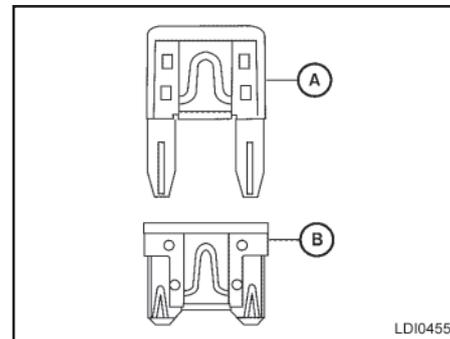
Dois tipos de fusíveis são usados. O tipo **A** é usado na caixa de fusíveis no compartimento do motor. O tipo **B** é usado na caixa de fusíveis no compartimento do passageiro.
