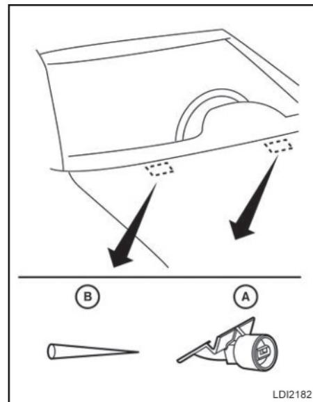
Caso a superfície do capô do motor seja encerada, tome cuidado para não deixar que a cera se acumule no ejetor do lavador do para-brisa ①. Isso poderá causar o entupimento ou a operação inadequada do lavador de para-brisa. Caso alguma coisa entre no bico, remova com uma agulha ou um pino pequeno ②.
