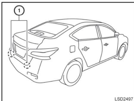
O sistema BSW utiliza sensores de radar ① instalados próximos ao para-choque traseiro, para detectar outros veículos em uma faixa adjacente.
