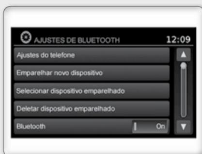
**NOTA: O procedimento de pareamento deve ser executado com o veículo parado. Se o veículo começar a se movimentar durante o procedimento, este será cancelado.**
