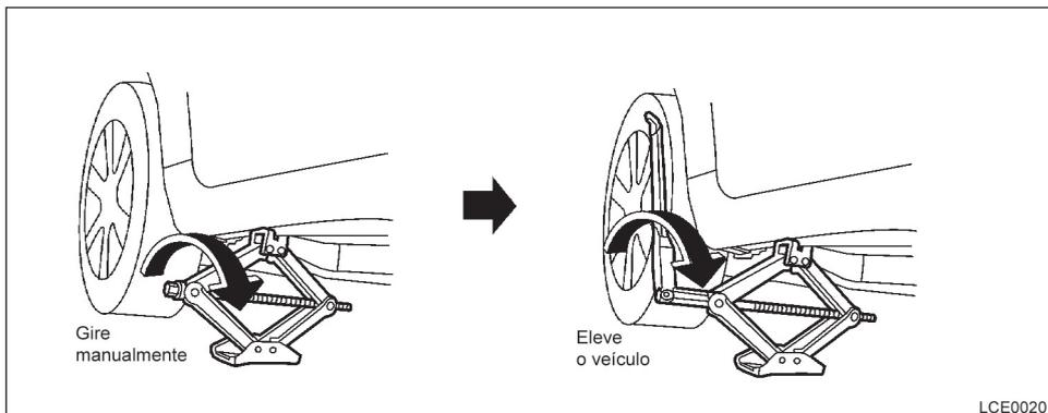
Sempre consulte as ilustrações adequadas quanto aos pontos de levantamento do veículo e instalação correta do macaco de acordo com o seu modelo de veículo específico e tipo de macaco.
