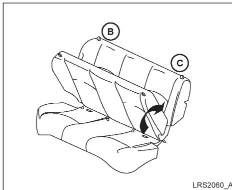
3. Para retornar o encosto traseiro para a posição vertical, levante o encosto e empurre-o para a posição. Pressione firmemente as zonas B e C para travar o encosto no lugar.
