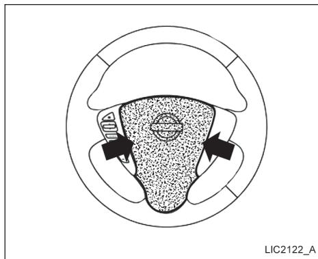
Para acionar a buzina, pressione o volante da direção próximo ao símbolo.
