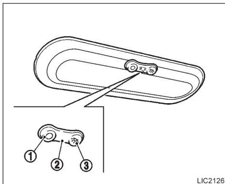
A luz interna possui um interruptor de três posições e funciona independentemente da posição do interruptor de ignição.
