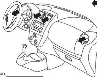
Fluxo de ar não passa pelo núcleo do aquecedor
