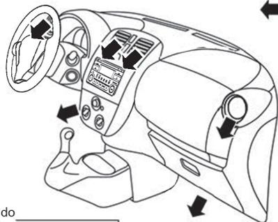
← : Fluxo de ar passa pelo núcleo do aquecedor
