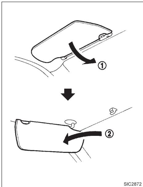
Para bloquear qualquer ofuscamento proveniente da parte dianteira, mova o para-sol para baixo ①.
