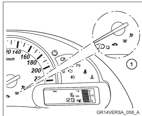
3. A luz indicadora
