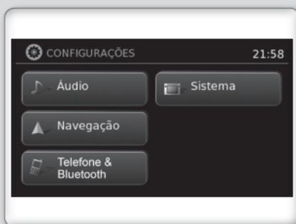
4. Inicie o processo de emparelhamento do aparelho. O sistema exibirá a mensagem: Inicie o emparelhamento com MY MARCH a partir de seu dispositivo Bluetooth. Se o dispositivo solicitar PIN, digite: 1234 para concluir o processo de emparelhamento.
