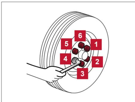
Aperte as porcas de roda o mais rapidamente possível, de acordo com o torque especificado, utilizando um torquímetro.
