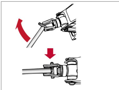
5. Para levantar o veículo, segure firmemente a alavanca do macaco e a haste com ambas as mãos, conforme mostrado.
