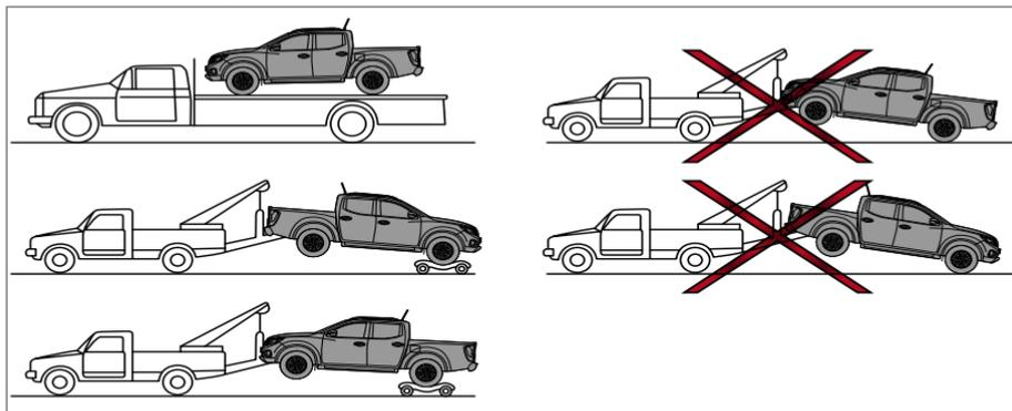
A Nissan recomenda que carrinhos de rebocagem sejam utilizados ao rebocar o seu veículo ou colocar o veículo em um caminhão com plataforma, como ilustrado.
