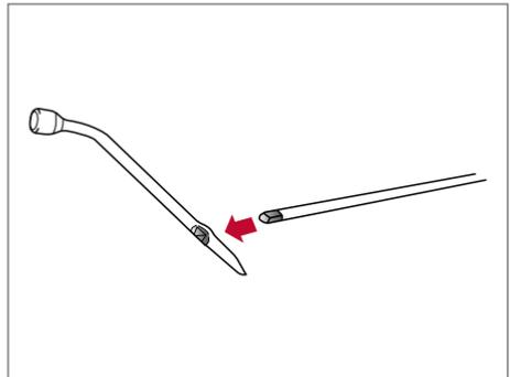
5. Localize a abertura oval na parte inferior central da tampa traseira. Insira a extremidade em "T" da haste através da abertura e direcione-a para o guincho do pneu reserva, localizado exatamente acima do pneu reserva.
