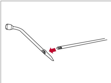
4. Coloque a haste montada no macaco, conforme mostrado.
