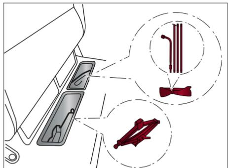
3. Para soltar o macaco de sua fixação gire o engate da haste na extremidade do macaco manualmente no sentido anti-horário. Remova o macaco do compartimento.
